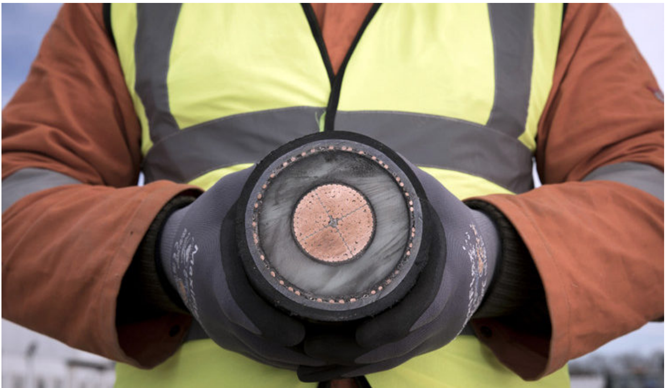
Das Unterseekabel im Durchschnitt. (Foto: National Grid)
